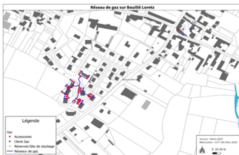
Fig.N°81 : Réseau de gaz de Bouillé-Loretz
