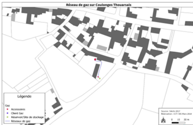
Fig.N°80 : Réseau de gaz de Coulonges-Thouarsais
